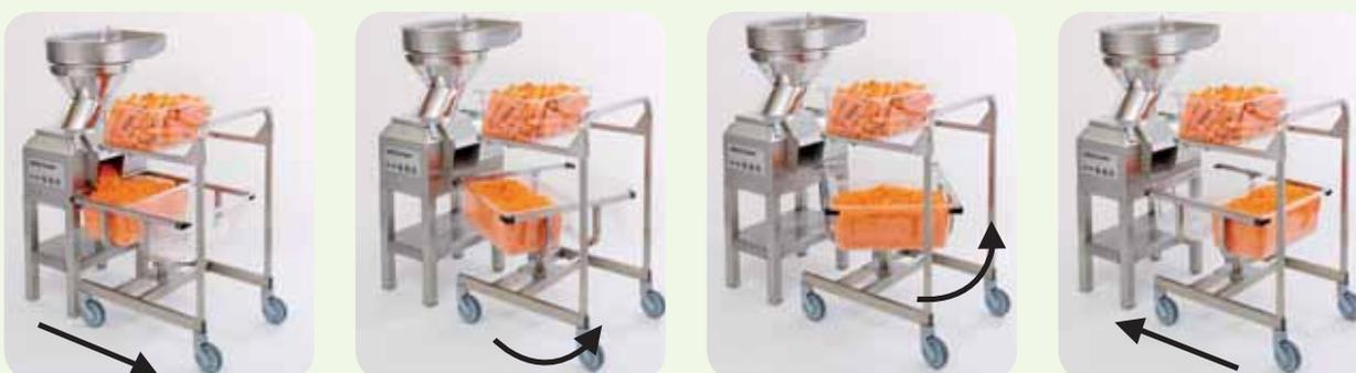
**Livello inferiore:** 2 vasche GN 1x1 per le verdure tagliate. Sistema girevole che permette di sostituire le vasche senza sforzo
