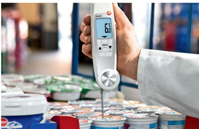
**3. Misura a penetrazione:** se la temperatura è sempre ancora troppo alta, successivamente viene fatta una misura a penetrazione in uno o più vasetti. La sonda viene introdotta nell'alimento attraverso il coperchio e misurata la temperatura interna corretta.
