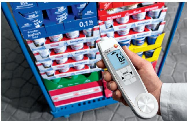
**1. Misura all'infrarosso della temperatura di superficie (non distruttiva):** prima di tutto fare una scansione della superficie con un termometro a infrarossi. Se la temperatura è plausibile, il controllo è terminato. Esempio: i vasetti di yogurt hanno una temperatura di 5 °C (valore nominale: max. 8 °C).
