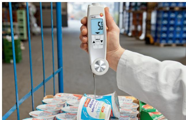
**2. Misura a contatto della temperatura di superficie (non distruttiva):** la temperatura di alcuni vasetti di yogurt è superiore a 8 °C? In questi casi viene sistemato un termometro a contatto tra due vasetti di yogurt e misurata la temperatura in quel punto.
